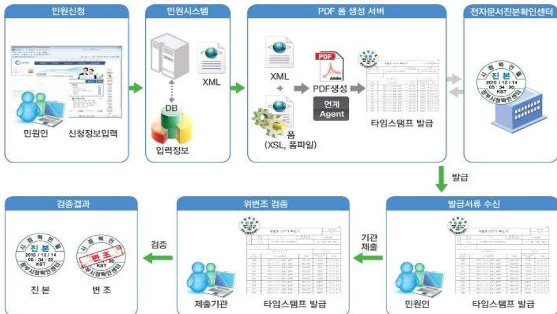
▣ 그림 36 | 전자문서진본확인시스템(GTSA) 서버 연동 지원(출처 : 행정안전부)
